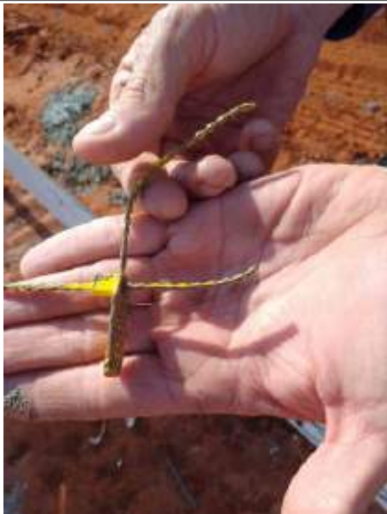
Lacre do caminhão de concreto
