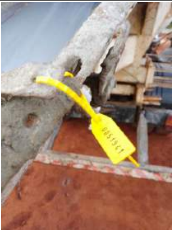
Lacre do caminhão de concreto
