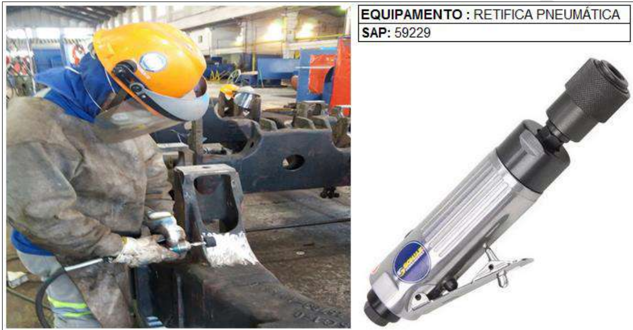
Figura 4 - Acabamento da limpeza utilizando a retifica pneumática.
