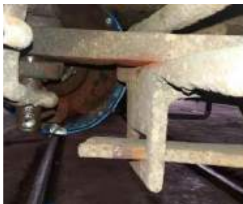
Figura 16- Suporte montado correto no vagão
