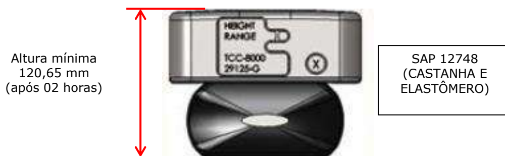
Figura 26: Verificação capacidade do elastômero modelo Miner TCC 4500
