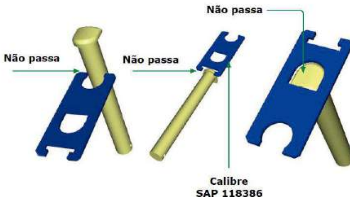
Figura 6: Inspeção com calibre não passa do limite de uso do pino da mandíbula.
