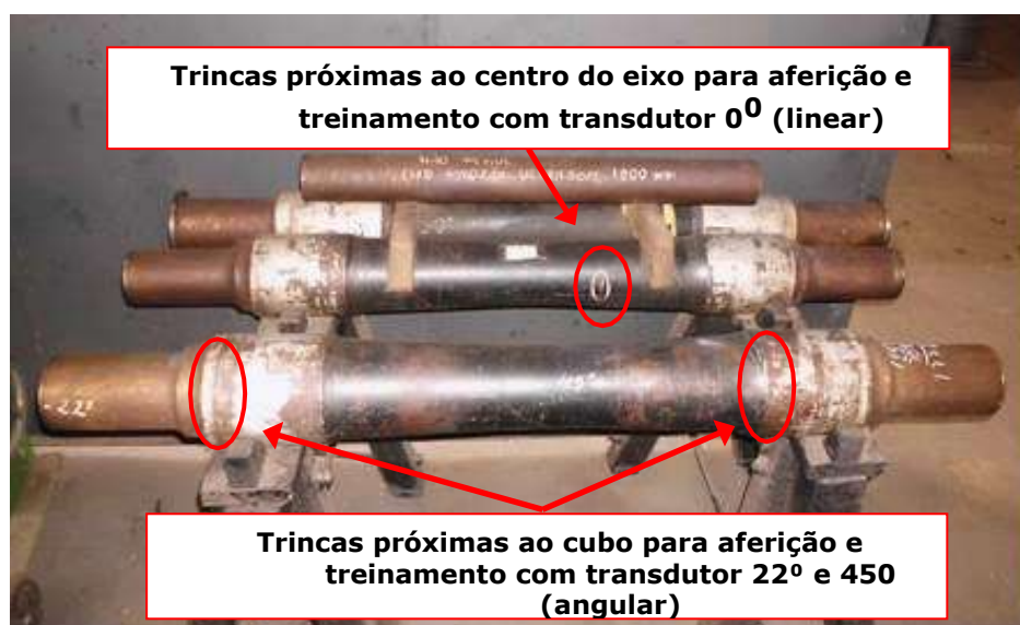
Figura 21 – Eixo padrão com trincas para aferição do aparelho e treinamento do inspetor
