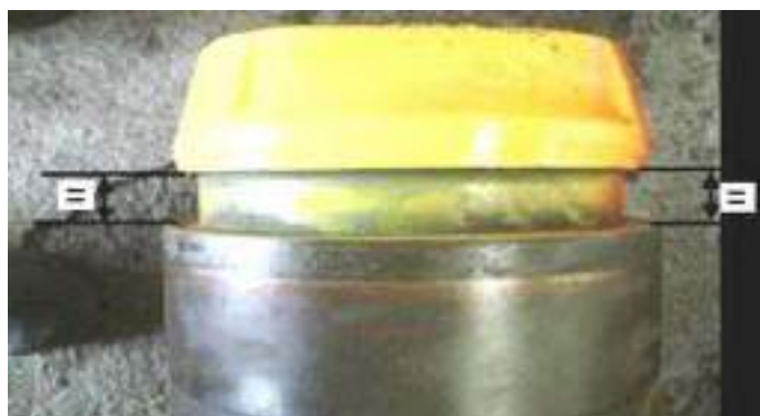
Figura 33 - Verificação visual do alinhamento da montagem da tampa do rolamento
