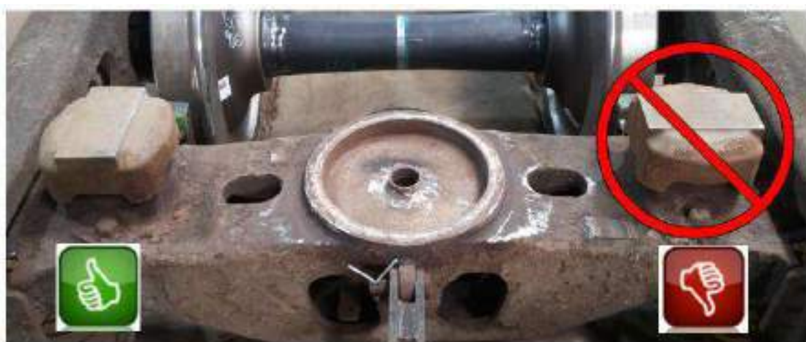
Figura 37: AB modelo Maxion (posição da tampa/capacete)
