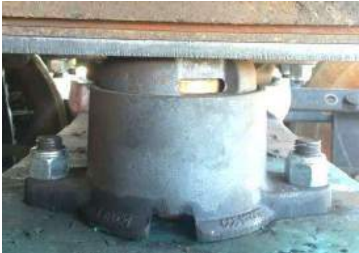
Figura 5: AB contato constante modelo CCB 3000 (Stucki) SAP 98525
