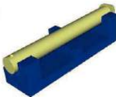
Figura 7: Verificação do empeno do pino da mandíbula com calibre SAP NNN.
