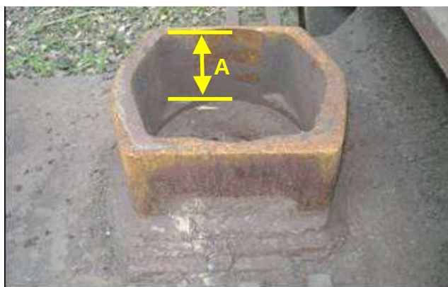
Figura 34: Profundidade do coxim modelo Maxion
