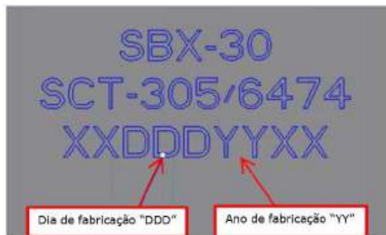
Figura 27: Data de fabricação do elastômero SBX 30
