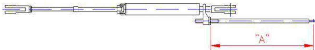
Figura 11 - Ajustador automático de folgas com a medida A
