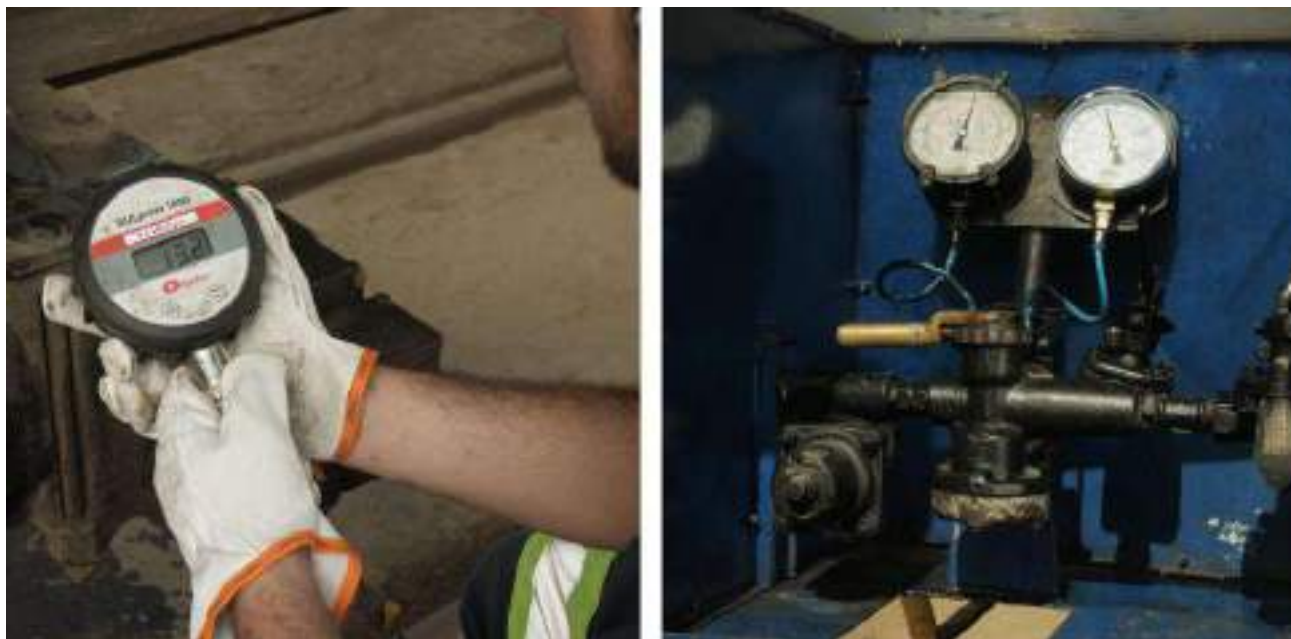
Figura 16- Teste de pressão do cilindro de freio
