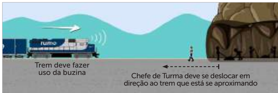
Figura 92. Onde a transmissão for comprometida, o Chefe de Turma deve se deslocar em direção ao trem que se aproxima assim que ouvir a buzina
