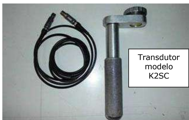
Figura 7 – Transdutor \varnothing 24 mm adaptado em “L” para inspeção linear (usa cabo conexões lemo01 x lemo01) para inspeção linear
