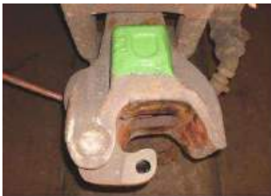
Figura 21: Identificação de inspeção do engate removido do vagão.
