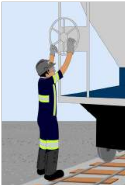
Figura 134. Ao deixar vagões no trecho, utilizar freios manuais e calços
