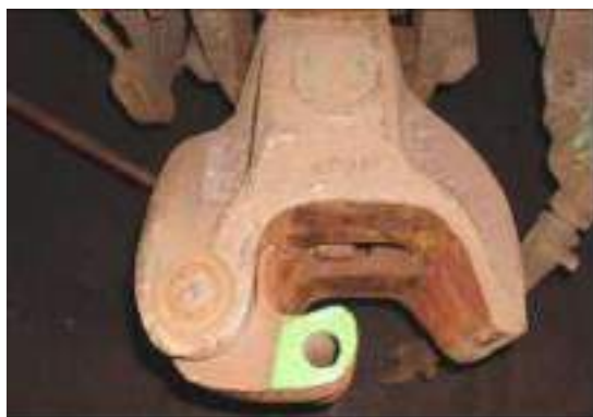
Figura 22: Identificação de inspeção do engate montado no vagão.
