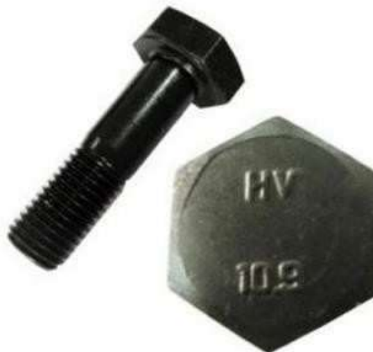
Fig 2: Gravação da classe do parafuso é feita na cabeça do mesmo. Parafuso classe 10.9
