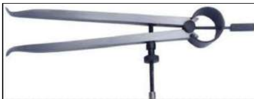
Figura 8: Compasso mecânico para verificação altura livre AB contato constante
