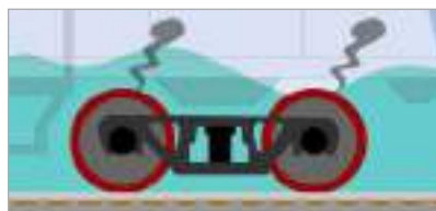
Figura 36. Superaquecimento de rodas
