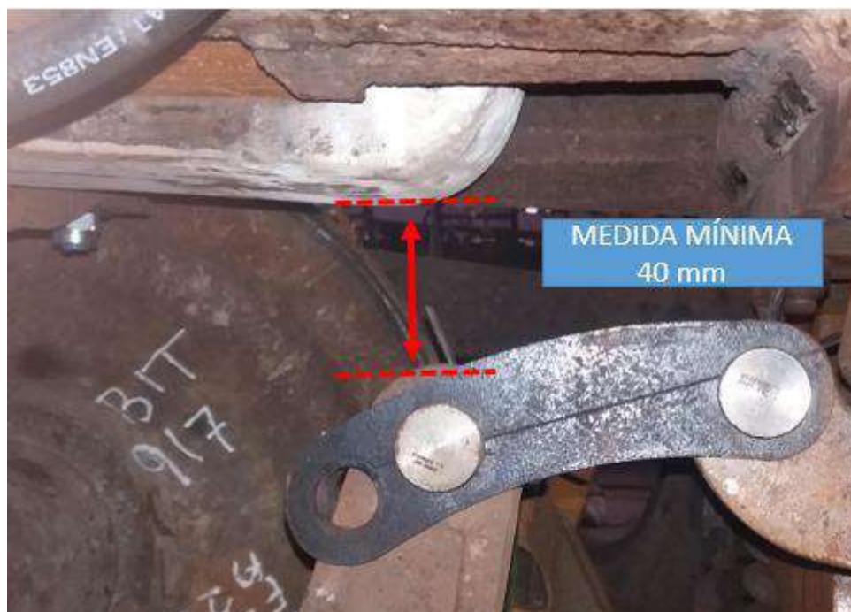
Figura 12 Medida padrão para evitar "QUEIXO DURO"
