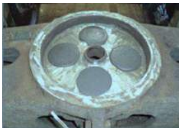
Figura 41: O grafite no prato pião só deve ser aplicado após ajuste do ampara balanço (SAP 2277)
