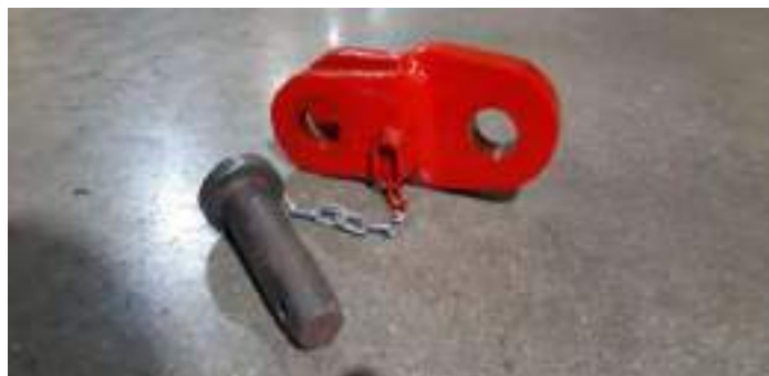
Figura 4 – Dispositivo para teste de freio para vagão sem truque
