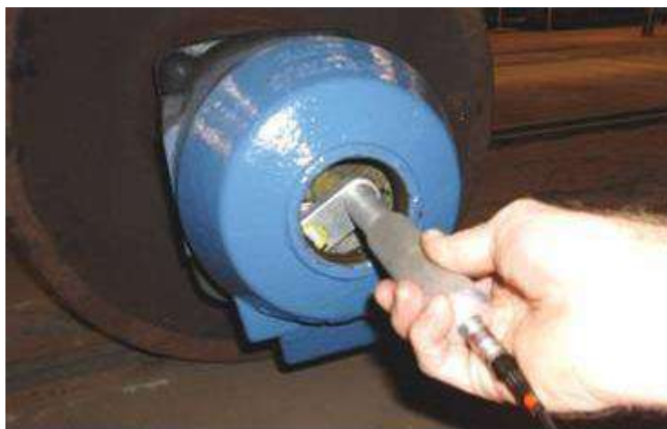
Figura 25 – Inspeção linear (rolamento caixa tampa bujão)
