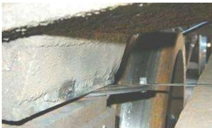
Figura 15: Forma correta utilização do calibre de palhetas
