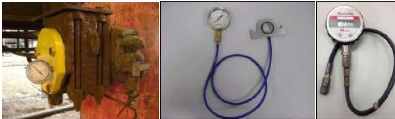
Figura 6 – Manômetros para tomada de pressão do cilindro de freio
