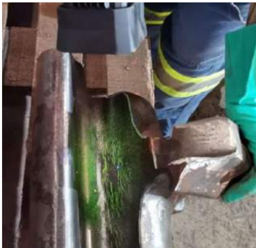
Figura 5: Inspeção de mandíbula com partícula magnética fluorescente.
