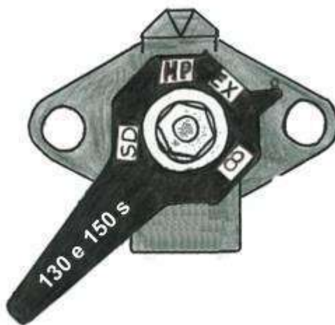
Figura 20 - Posição Super Restrito alívio de 130 a 150 segundos
