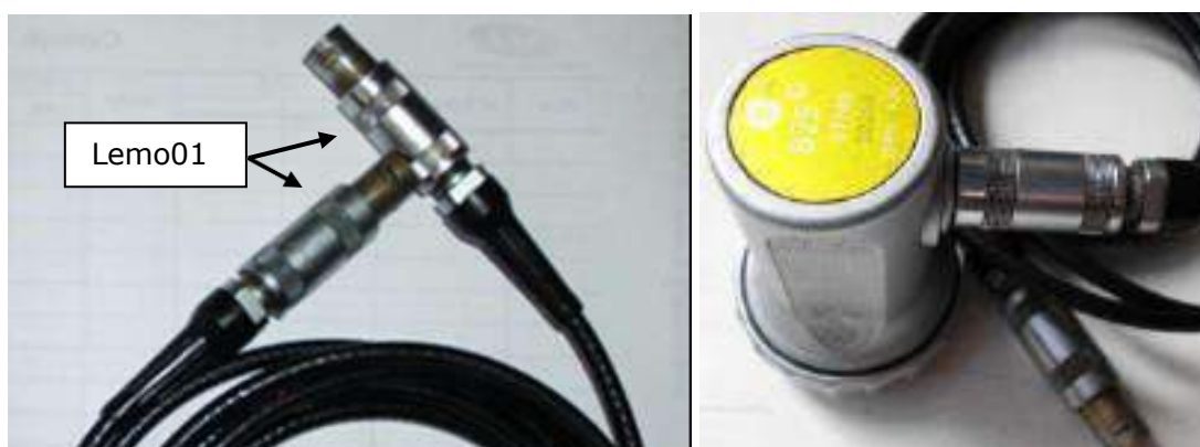
Figura 4 – Cabo conexões tipo lemo01 x lemo01 (para transdutor \varnothing 24mm) SAP109971
