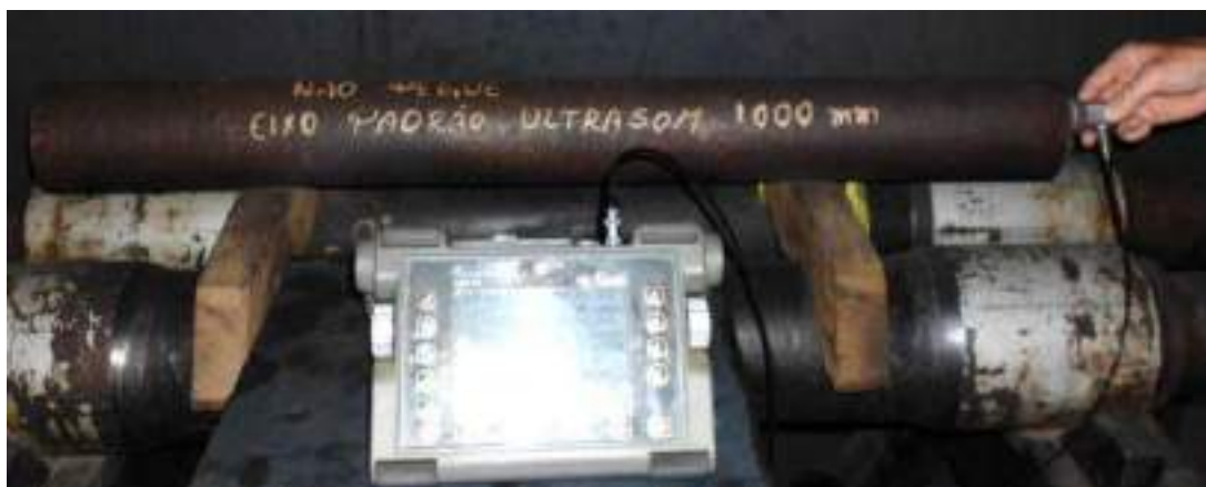
Figura 18 – Eixo padrão de 1.000 mm (calibração)
