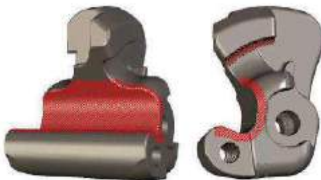
Figura 4: Locais críticos da mandíbula para inspeção de trinca.
