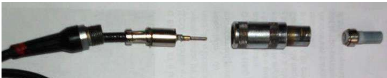
Figura 6 – Sequência de montagem da ponteira do cabo lemo
