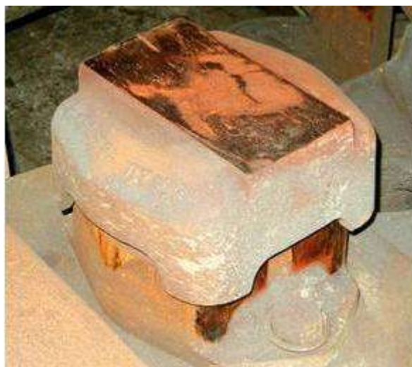
Figura 4: AB contato constante modelo Maxion (com molas internas)
