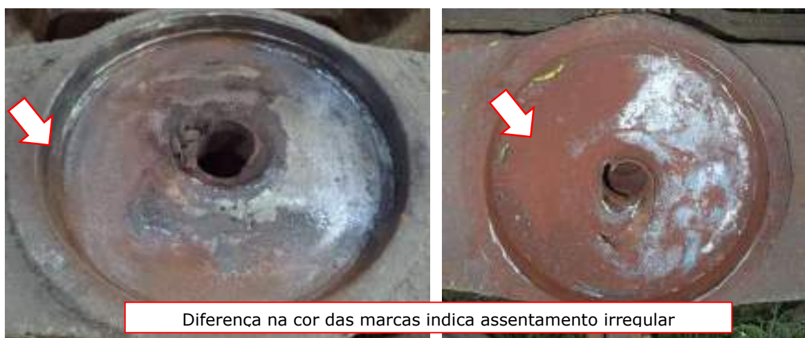
Figura 11: Diferenças de coloração indicam assentamento irregular
