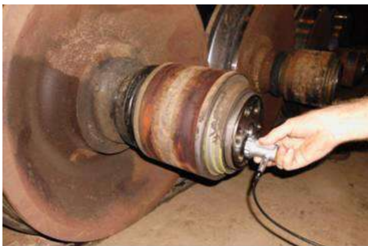
Figura 23 – Inspeção linear (com rolamento cartucho)
