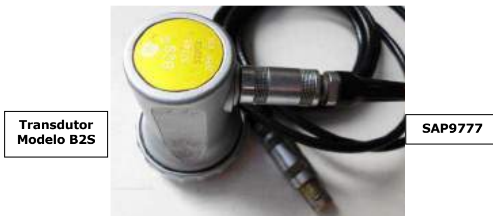
Figura 8 – Transdutor linear \varnothing 24 mm – 0° (usa cabo conexões lemo01 x lemo01)
