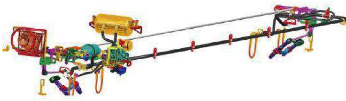
Figura 3 – Disposição dos componentes de freio (Ref. GBMX)
