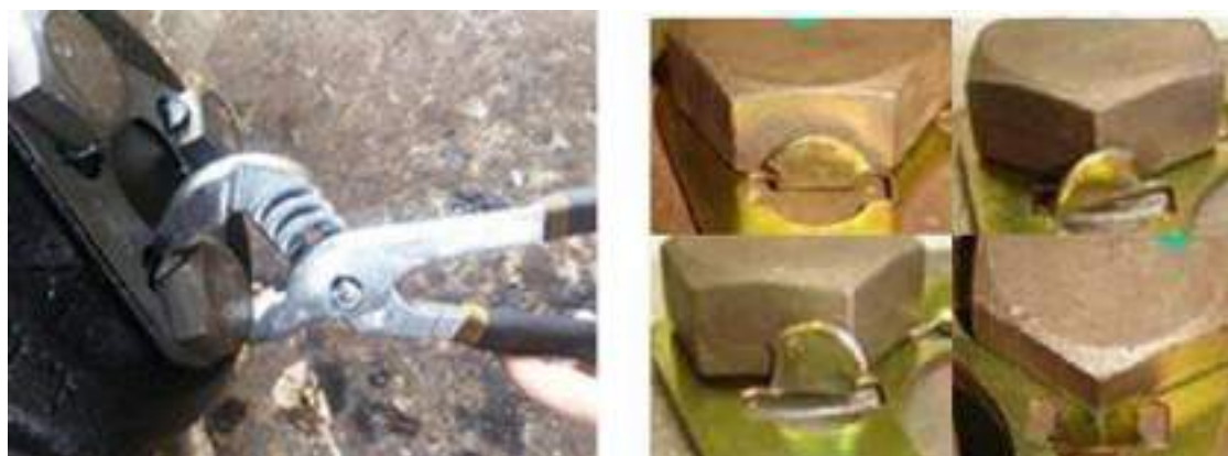
Figura 34 - Travamento dos parafusos (rolamento cartucho)
