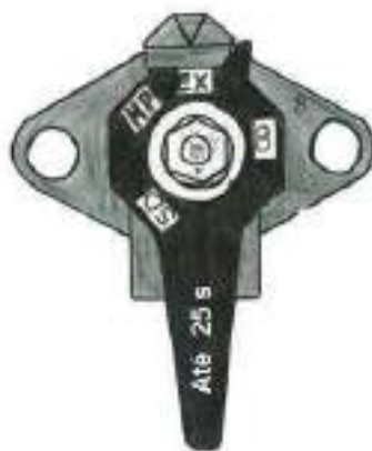
Figura 18 - Posição Normal alívio em até 25 segundos
