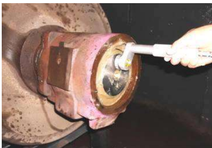
Figura 24 – Inspeção linear (rolamento caixa tampa cega)
