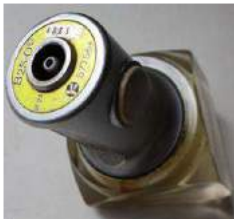
Figura 10 – Transdutor 45° (usa cabo lemo01 x lemo01)
