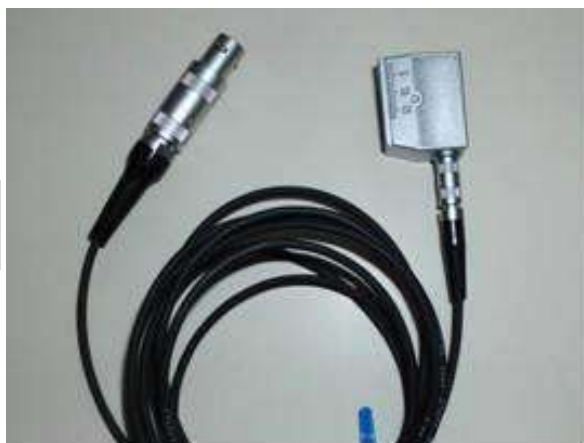
Figura 12 – Transdutor angular 45° 02mgz – Alternativo (usa cabo lemo01 x lemo00)
