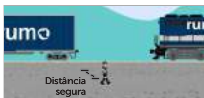
Figura 113. Mantenha-se fora do gabarito durante manobras
