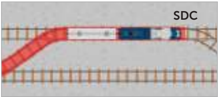
Figura 159. Trem parado antes da SDC, não ocupando a SB seguinte
