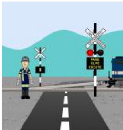
Figura 132. Colaborador protegendo PN em transporte de barras de trilhos
