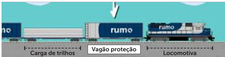
Figura 109. Utilize vagão de proteção para cargas com risco ao Maquinista
