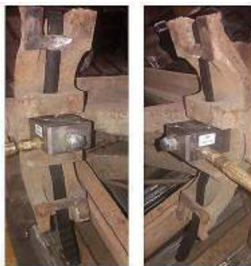
Figura 3 - Instalação das células de carga
