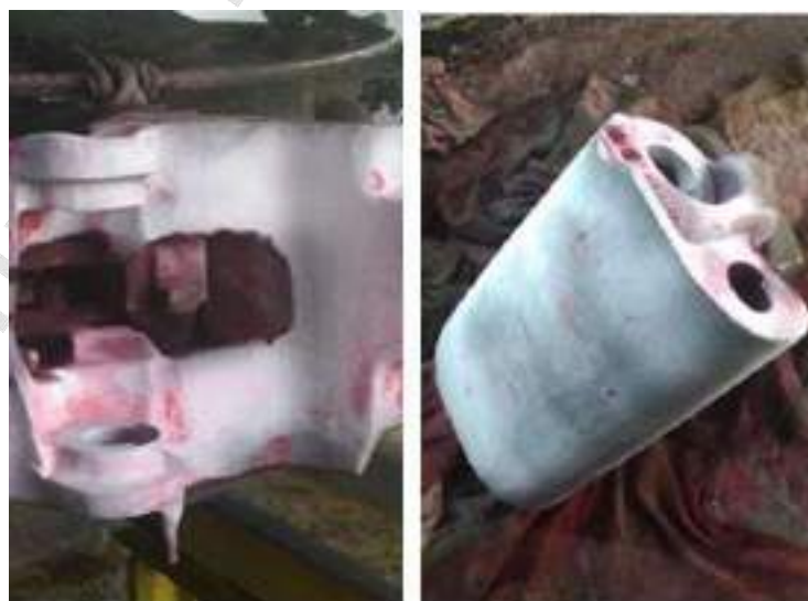
Figura 15 - Engate e mandíbula após aplicação do revelador.
