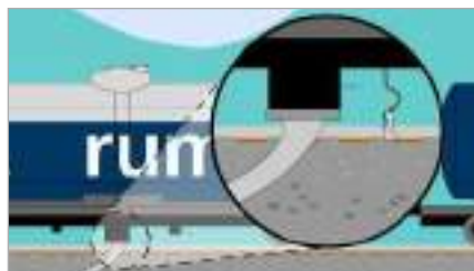
Figura 138. Cabo terra em vagão tanque
