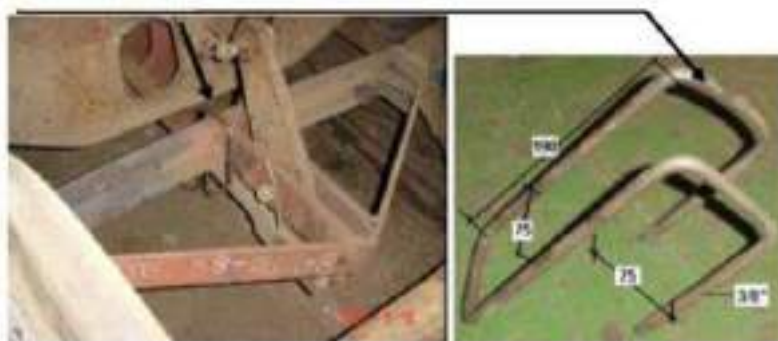
Figura 3 - Aplicação do antiqueda na barra de compressão
