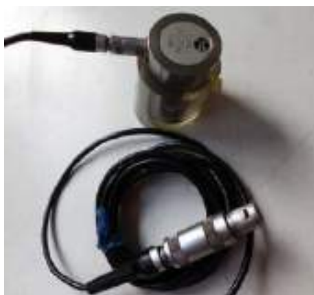
Figura 11 – Transdutor 22° (usa cabo lemo00 x lemo01)
