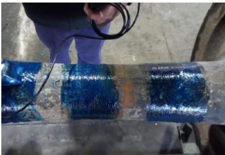
Figura 27 – Aplicação de graxa no eixo
