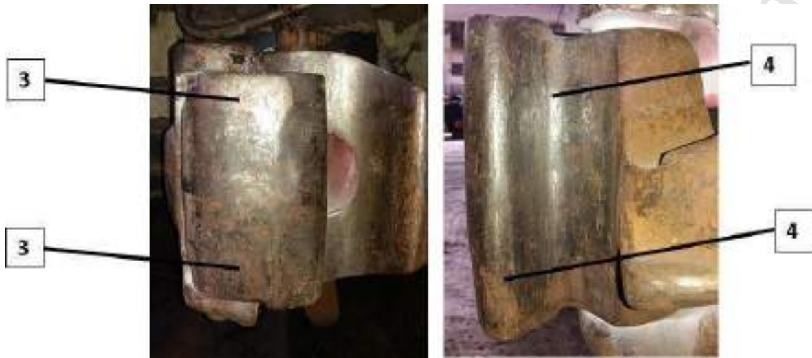
Figura 9 - Pontos da mandíbula suscetíveis a trincas.
