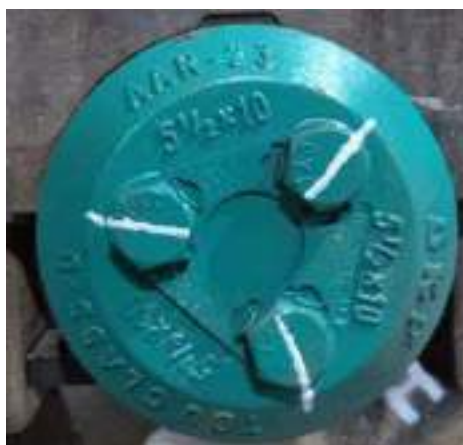
Figura 35 – Marcação da posição dos parafusos (após torque)
