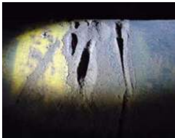
Figura 15 – Exemplo de marcas profundas em eixos (substituir se > 3,2 mm)
