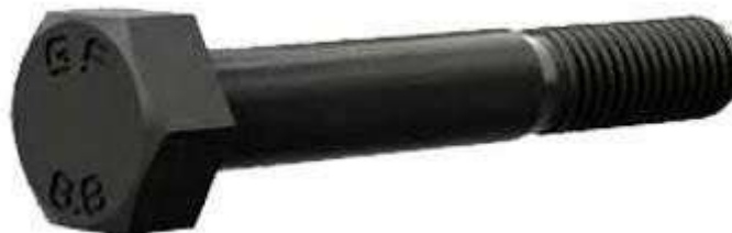
Fig 1: Gravação da classe do parafuso é feita na cabeça do mesmo. Parafuso classe 8.8.
