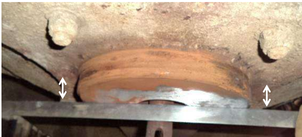
Figura 14: Verificação do prato pião superior (não deve estar em forma de cunha)
