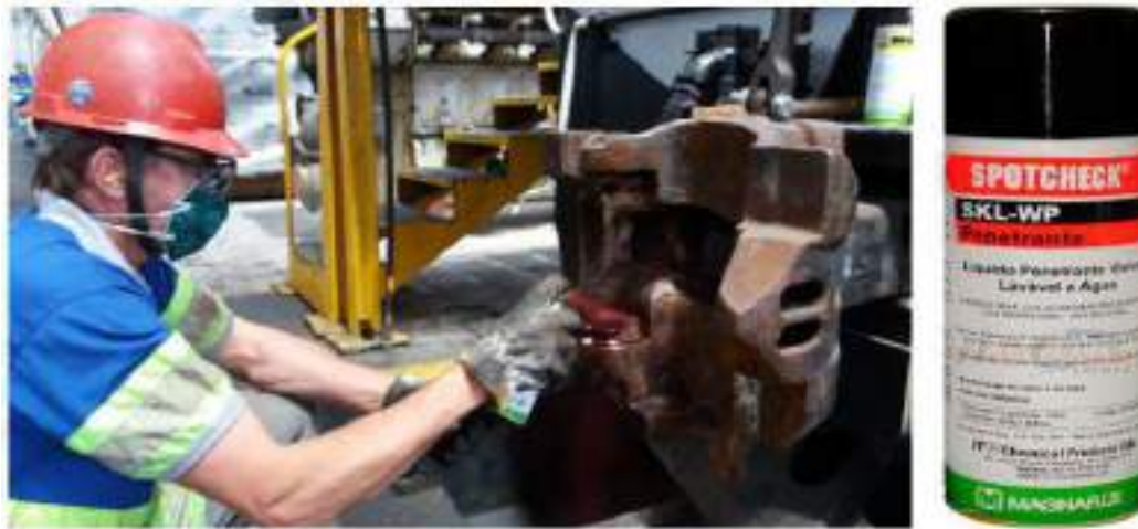
Figura 11 - Aplicação do Spray Penetrante.
