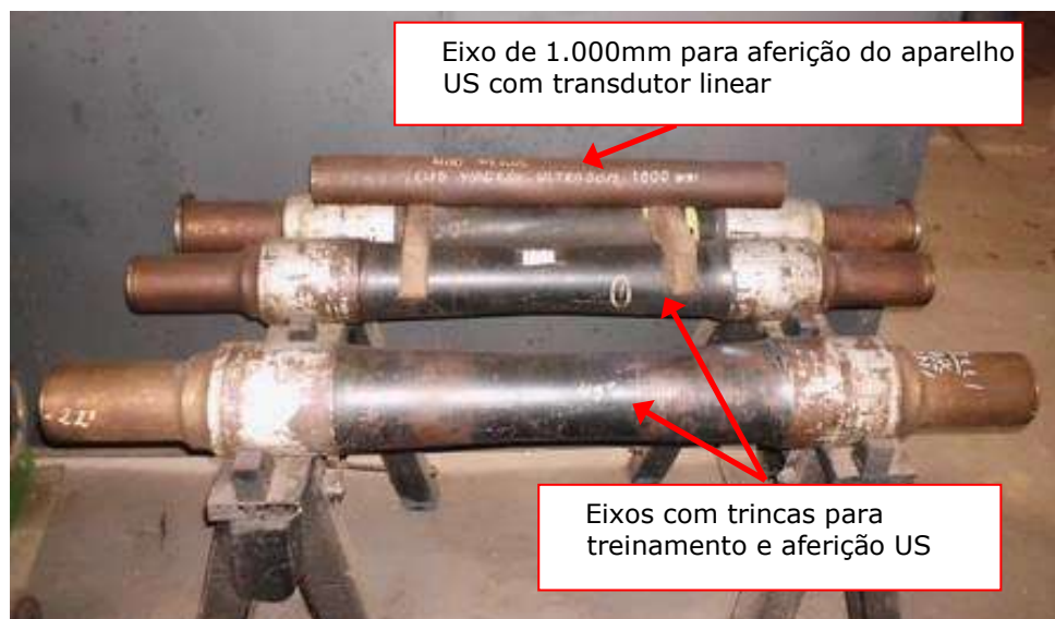
Figura 13 – Eixos para aferição do aparelho e treinamento diário do inspetor
