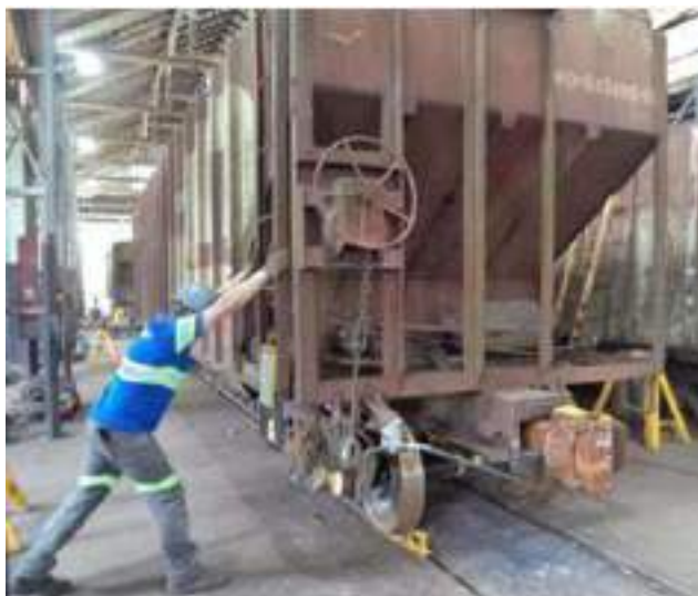
Figura 10: Como verificar se o vagão está com balanço excessivo
