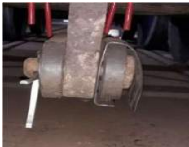
Figura 4 - Trava do pino da barra de compressão
