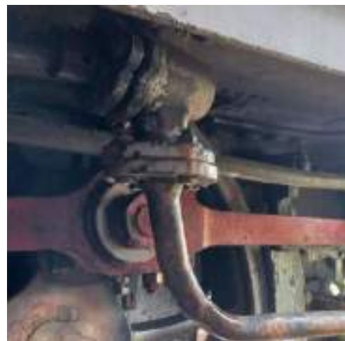
Flange com Vazamento.
