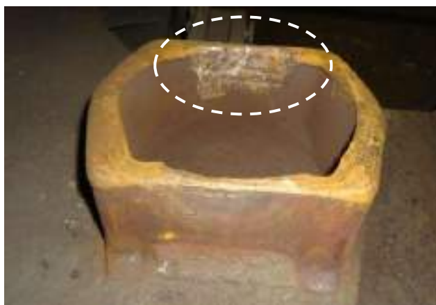
Figura 35: Pequenos desgastes nas bordas podem ser recuperados
