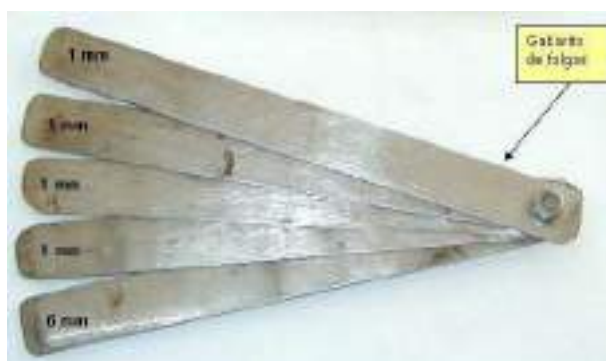
Figura 7: Calibre de lâminas para ampara balanço de folga SAP 7274
