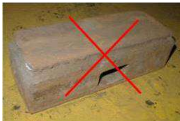
Figura 19: Proibido soldar chapas sobre a castanha
