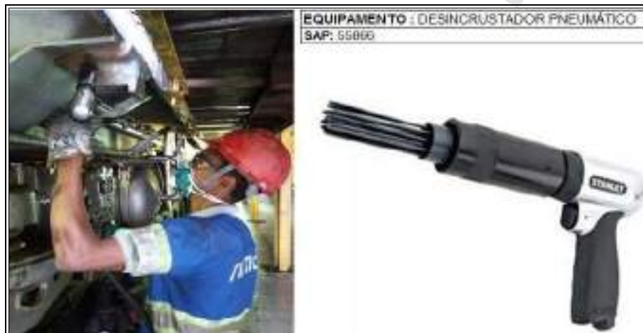
Figura 2 - Remoção da tinta utilizando a desincrustadeira pneumática.
