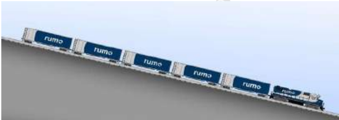
Figura 7 - Engates com esforços em compressão.
