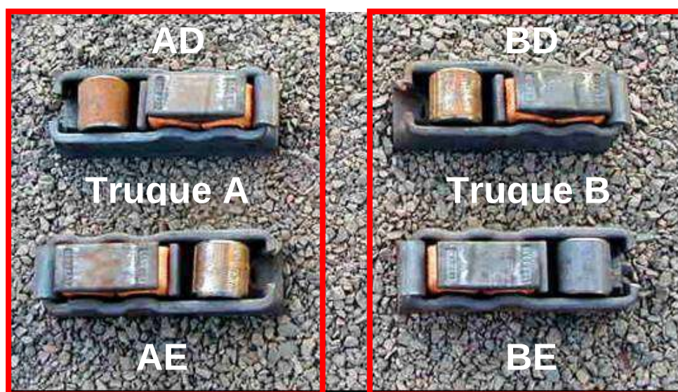
Figura 25: Modelo Stucki ISB-8 (disposição dos componentes)
