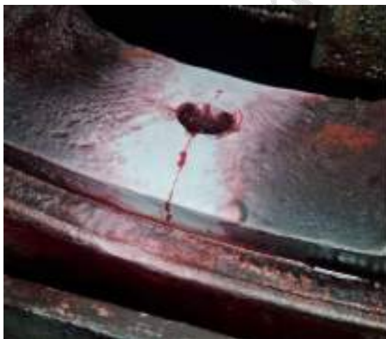
Fig. 3 – Trinca na roda – Teste com Líquido Penetrante.
