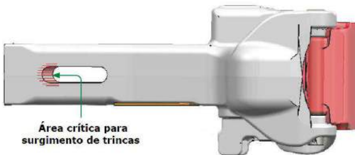
Figura 11: Área de inspeção criteriosa de trincas por END.
