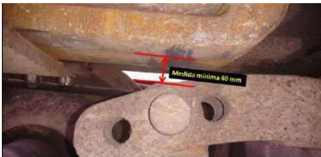
Figura 1 - Distância entre a abraçadeira e o setor de graduação
